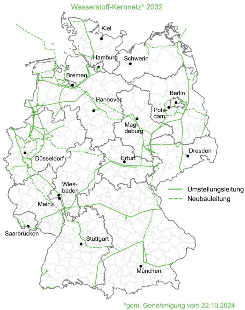
Abbildung 9: Genehmigte Planung für Wasserstoff-Kernetz [Quelle: FNB Gas 2024]
